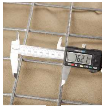
Mesh Aperture Test
